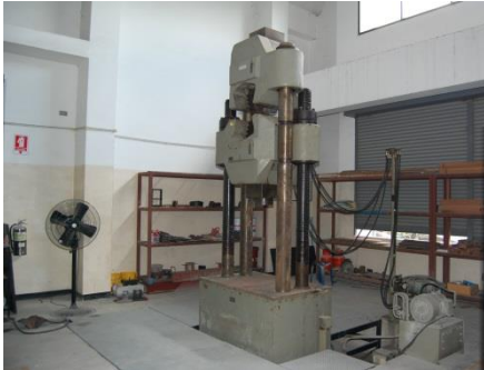
รูปที่ 4.1-3 เครื่องทดสอบ Universal Testing Machine ขนาด 200 ton
