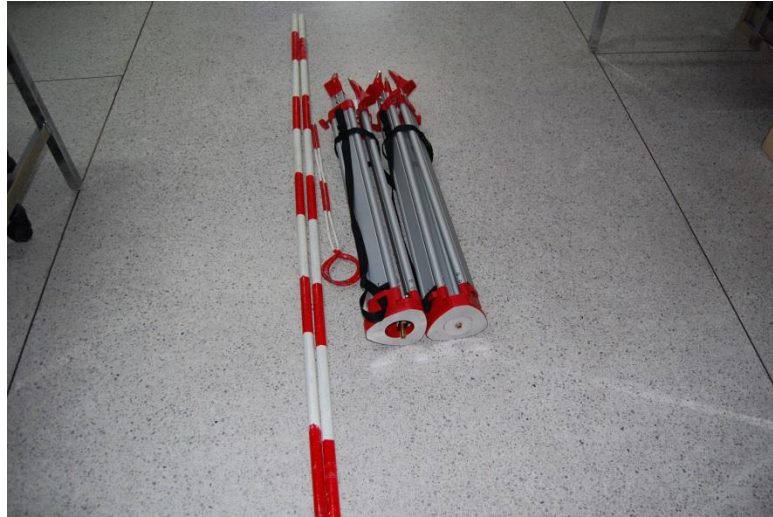
รูปที่ 4.1-70 อุปกรณ์เสริมต่างๆ ได้แก่ ขากล้อง, Staff, Pole, Pin
