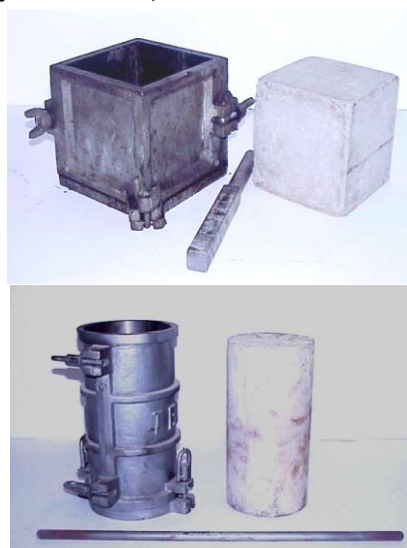
รูปที่ 4.1-26 แบบหล่อก้อนตัวอย่างทดสอบ (Cube Mold) ทรงกระบอก และทรงลูกบาศก์
