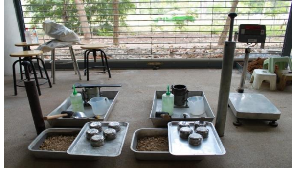
5. ชุดทดสอบการบดอัดดินแบบมาตรฐานและแบบสูงกว่ามาตรฐาน (Compaction)
