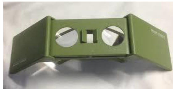
4. เครื่องอ่านแผนที่ภาพถ่ายทางอากาศขนาดเล็ก ยี่ห้อ WILD รุ่น TSP 1
