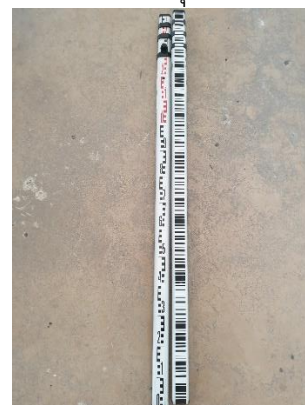
6. ไม้วัดระดับ ชนิด DUAL SCALE ยี่ห้อ LEICA รุ่น GSS 111
