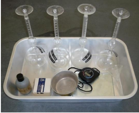
1. ชุดทดสอบการหาค่าความถ่วงจำเพาะของซีเมนต์
