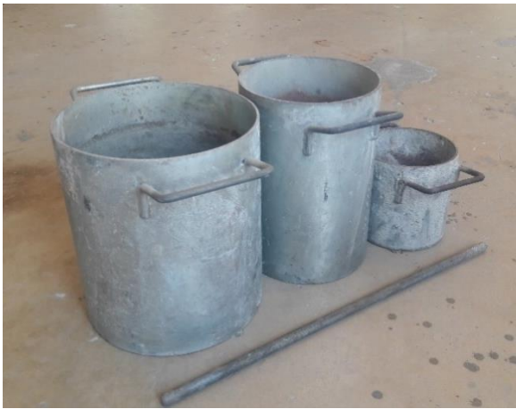
7. ชุดทดสอบการหาค่าหน่วยน้ำหนักของคอนกรีต
