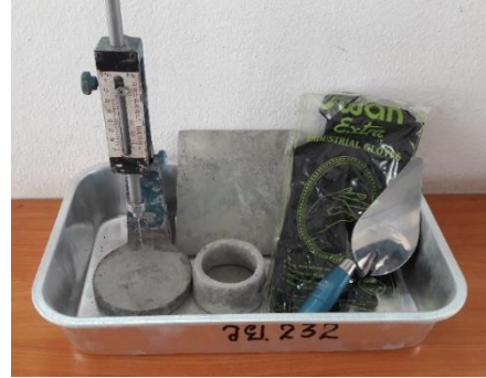
2. ชุดทดสอบการหาค่าขีดจำกัดความชื้นเหลวปกติของซีเมนต์เพส
