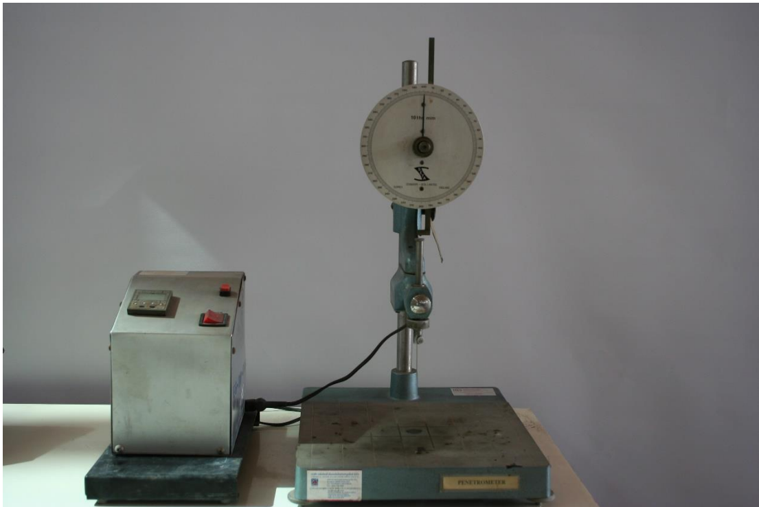
ชุดทดสอบเพนิเทรชันของแอสฟัลต์ซีเมนต์
