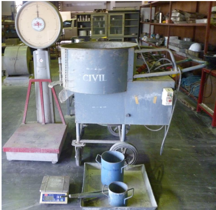
ชุดทดสอบการหาค่าหน่วยน้ำหนักของคอนกรีต
