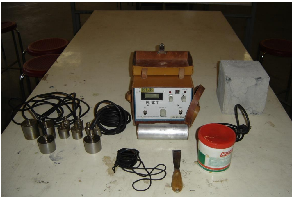
ชุดทดสอบแบบไม่ทำลาย : ชุดทดสอบ Ultra Pulse Velocity (UPV)
