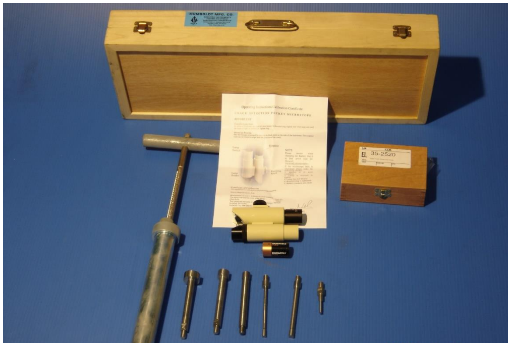
ชุดทดสอบเวลาการก่อตัวของคอนกรีต
