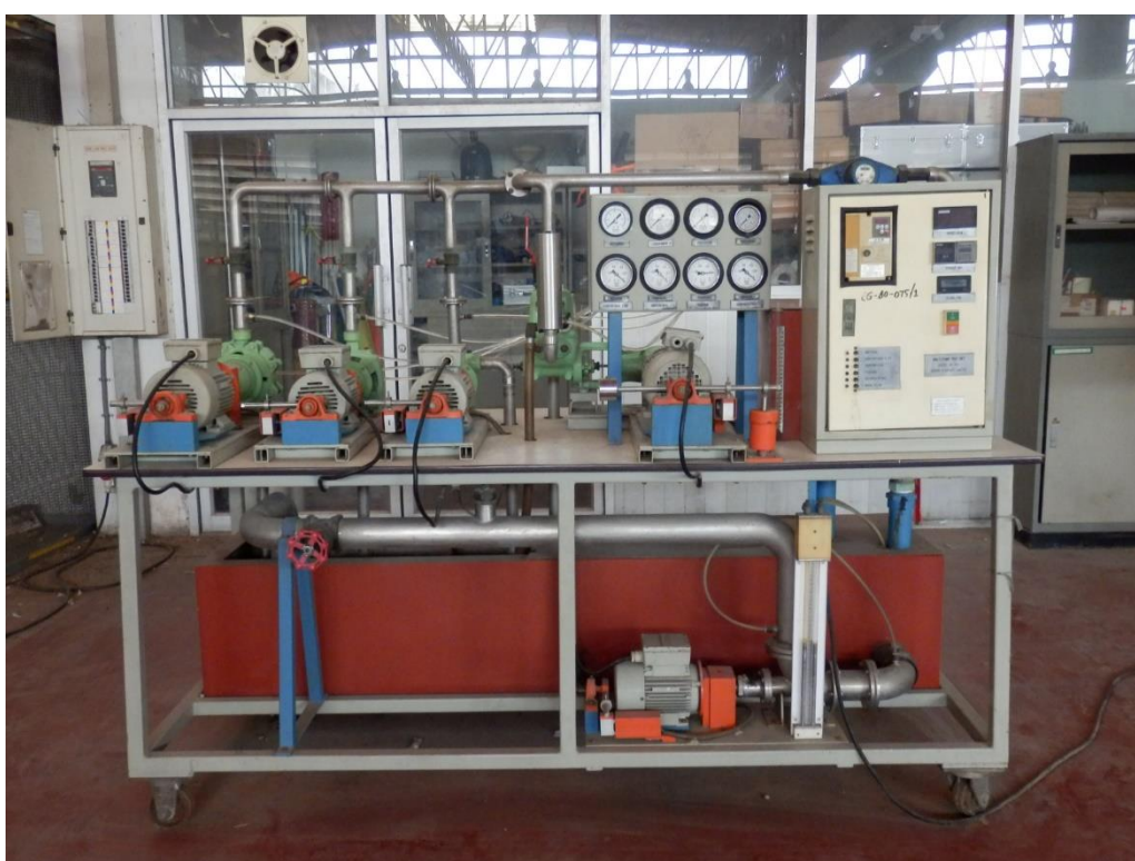
ชุดทดสอบการทำงานของเครื่องสูบน้ำ
