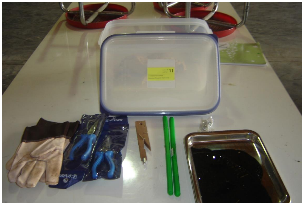
ชุดทดสอบการหลุดออกของแอสฟัลต์
