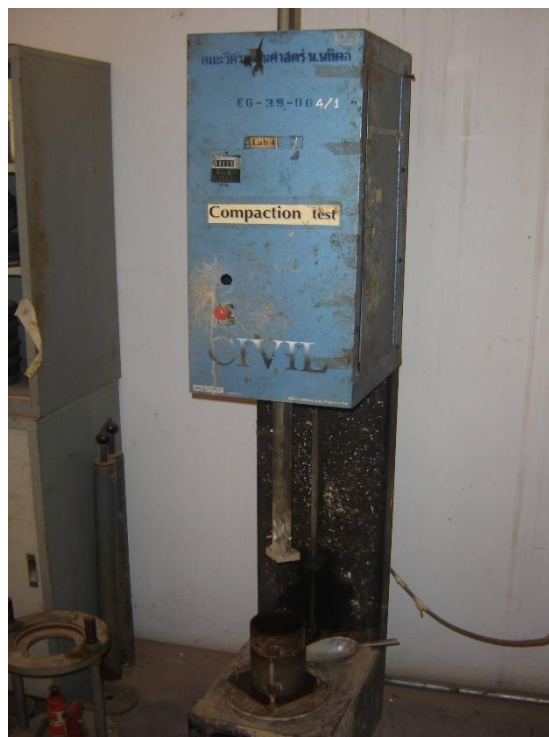
ชุดทดสอบการบดอัดดินแบบมาตรฐานและแบบสูงกว่ามาตรฐาน
