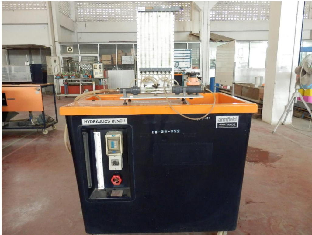
ชุดทดสอบการวัดการไหลในท่อปิดและการศึกษาทฤษฎีของเบอร์นูลี
