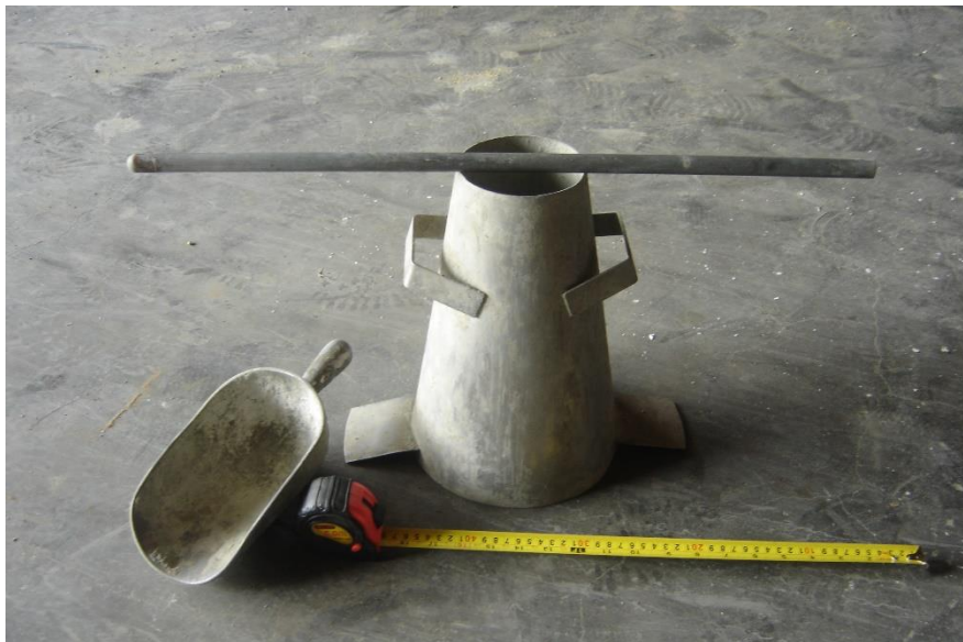
ชุดทดสอบการหาค่าการยุบตัวของคอนกรีต
