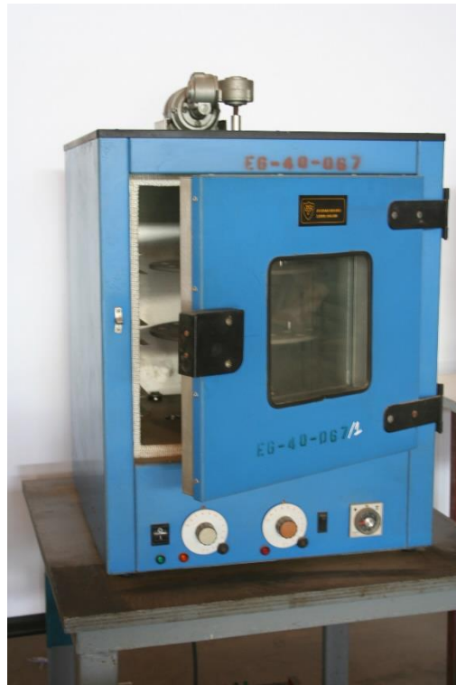
ชุดทดสอบการสูญเสียของวัสดุแอสฟัลต์เมื่อได้รับความร้อน
