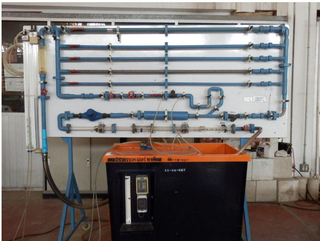
ชุดทดสอบการสูญเสียแรงดันในท่อปิด
