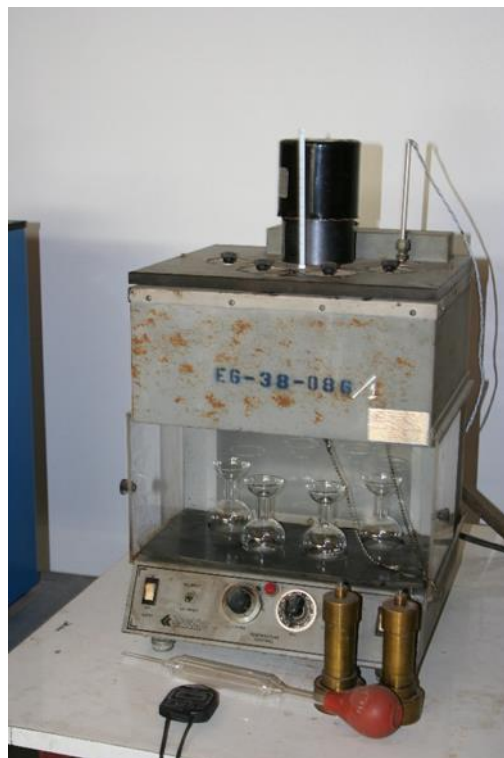
ชุดทดสอบความชื้นของแอสฟัลต์เหลวแบบเซย์โบลูโรล
