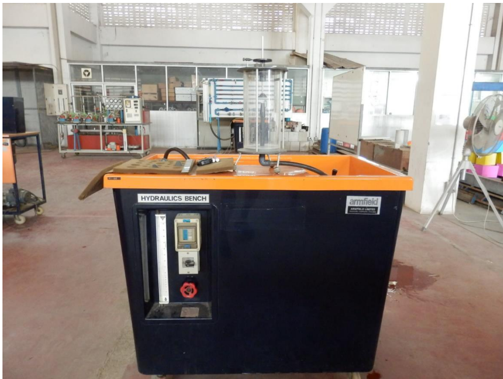
ชุดทดสอบการไหลพุ่งกระทบฉากกัน
