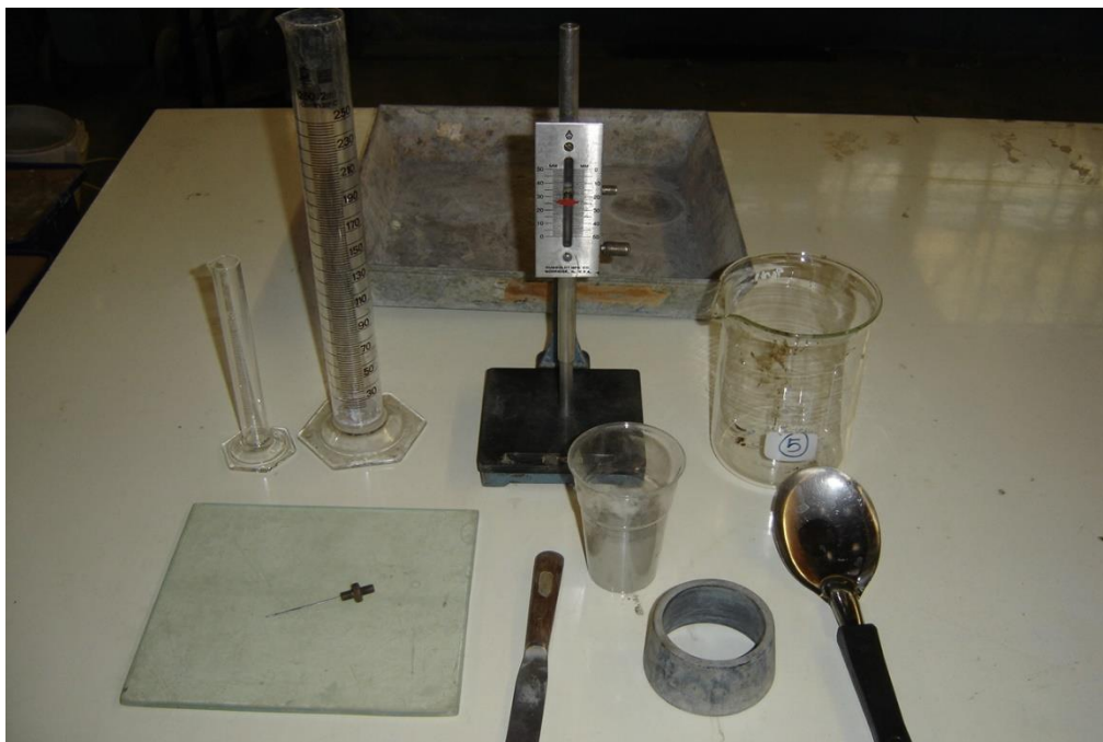
ชุดทดสอบหาค่าขีดจำกัดความชื้นเหลวปกติและระยะเวลาการก่อตัวของซีเมนต์เพสต์
