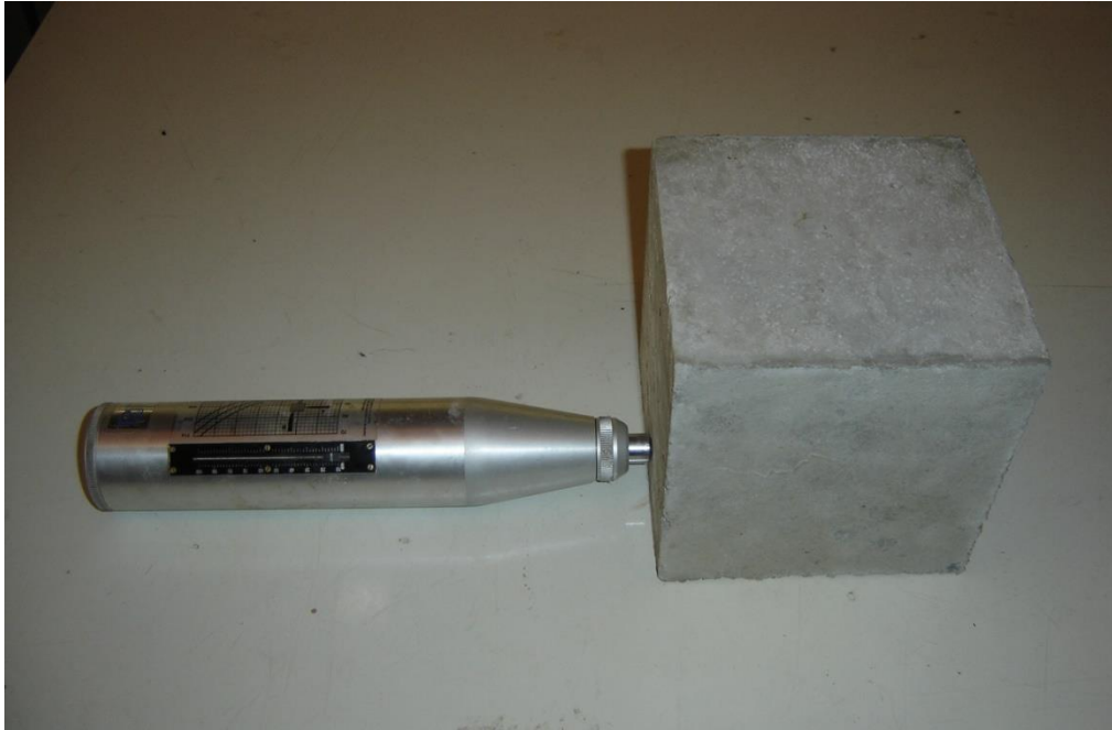
ชุดทดสอบแบบไม่ทำลาย : ชุดทดสอบ Rebound Hammer
