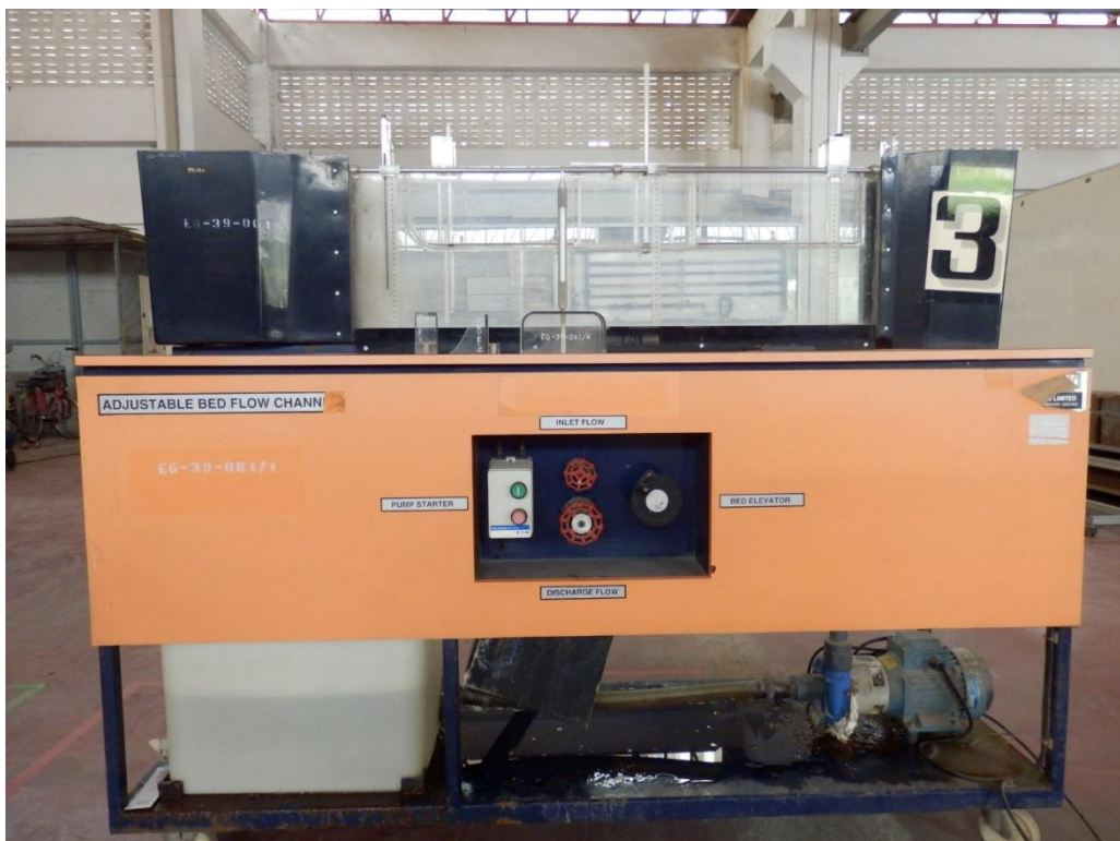
ชุดทดสอบการไหลตลอดประตุน้ำและไฮดรอลิกจัม
