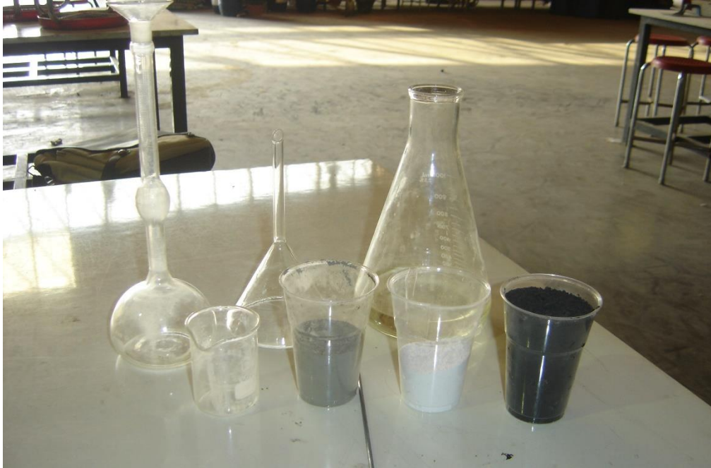
ชุดทดสอบการหาค่าความถ่วงจำเพาะของปูนซีเมนต์
