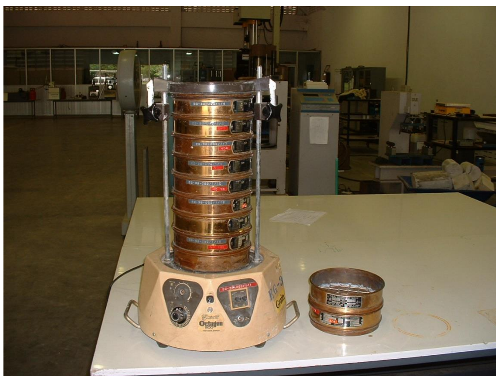
ชุดทดสอบการจำแนกขนาดของเม็ดดินโดยวิธีตะแกรงร่อน
