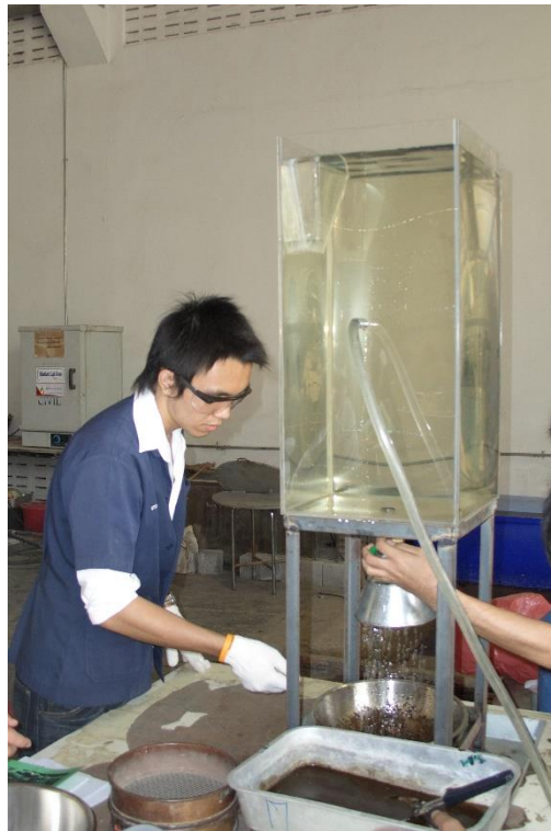
ชุดทดสอบความสามารถในการเคลือบผิว และทนน้ำของแอสฟัลต์อีมีลชัน
