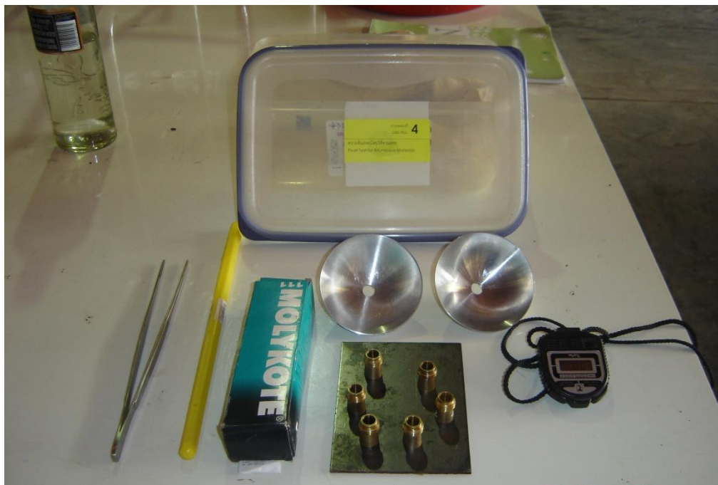
ชุดทดสอบความแข็งของแอสฟัลต์โดยใช้จานลอย
