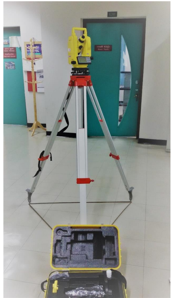
เครื่องมือสำรวจเพื่อการก่อสร้างด้วย Laser
