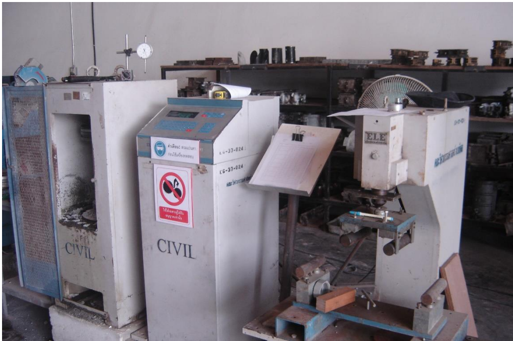
ชุดทดสอบกำลังอัดและกำลังดัด
