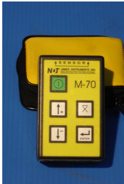
ชุดทดสอบแบบไม่ทำลาย : เครื่องมือวัดความชื้นภายในคอนกรีต
