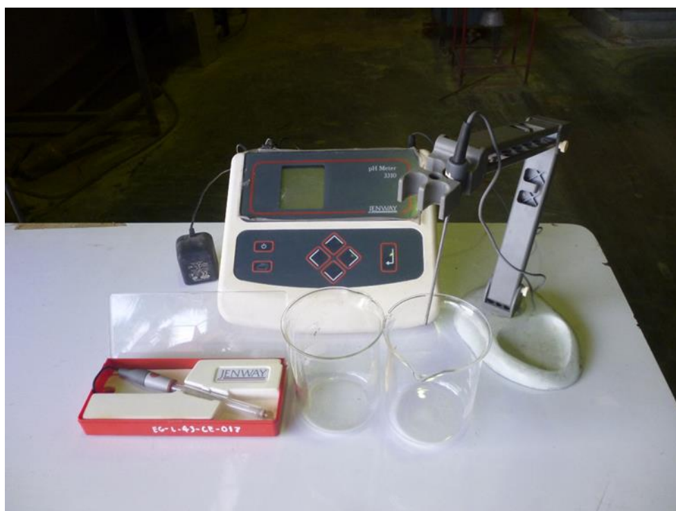
ชุดทดสอบความเป็นกรด-ด่าง ปริมาณคลอไรด์ และซัลเฟต
