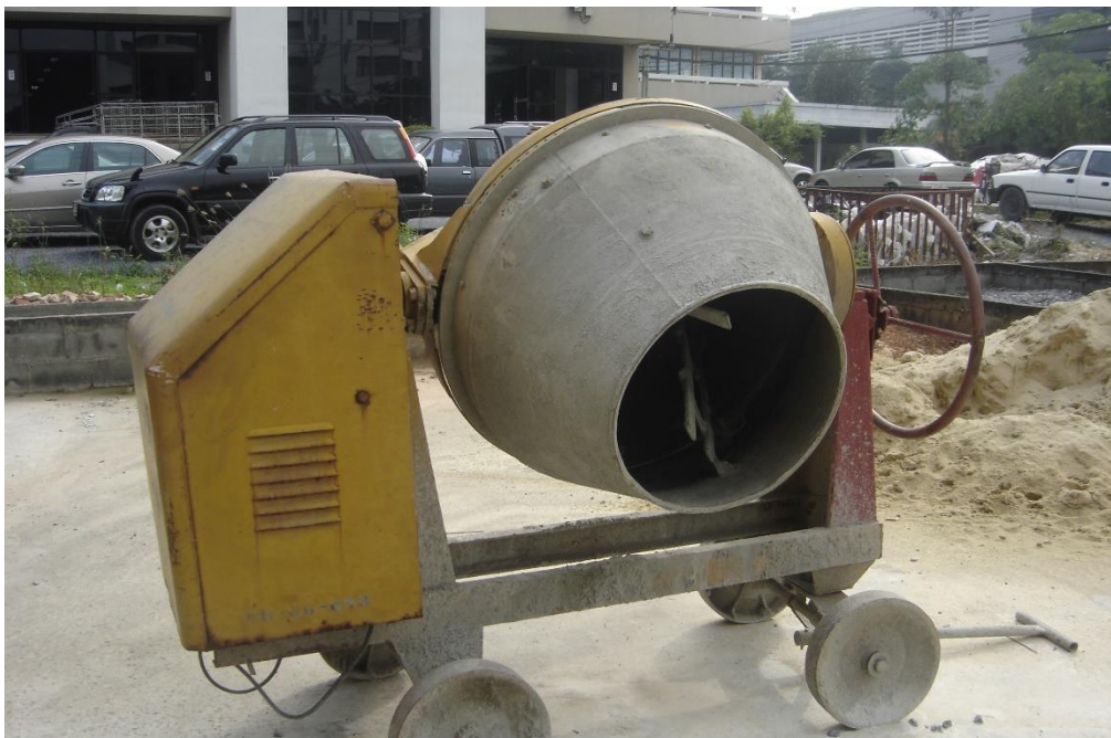
ชุดเครื่องผสมคอนกรีตแบบ Drum Mixer
