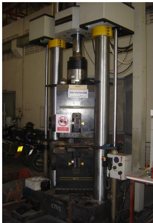
ชุดทดสอบ Universal Testing Machine ขนาด 1000 kN
