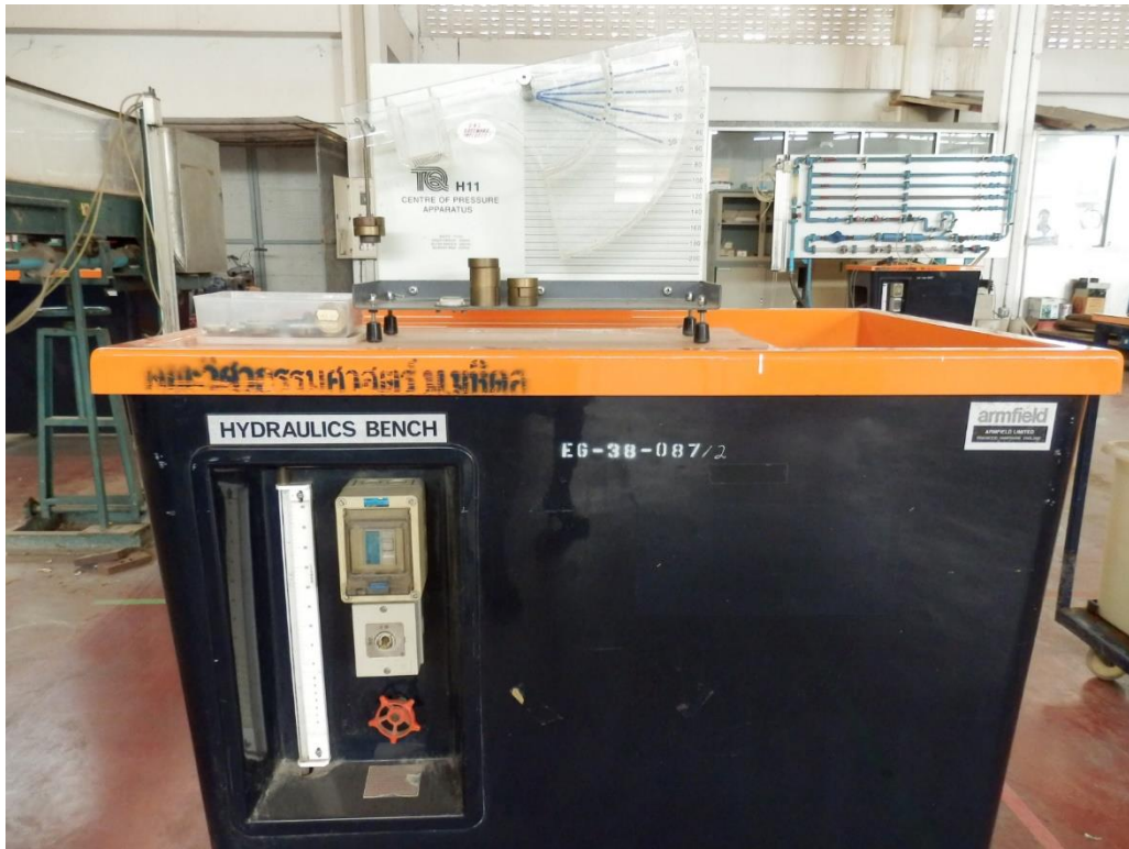
ชุดทดสอบการหาจุดศูนย์กลางแรงดันของของไหล
