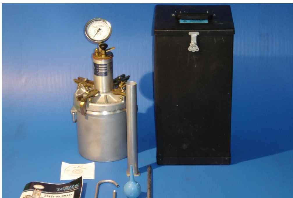
ชุดทดสอบปริมาณอากาศในคอนกรีตสด
