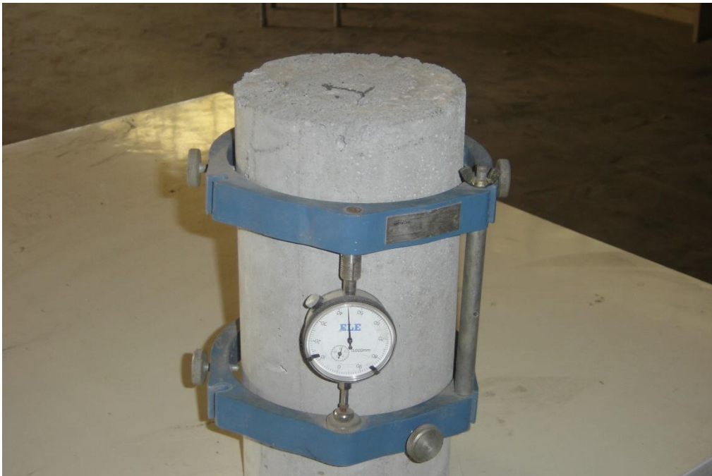
ชุดทดสอบอีลาสติคโมดูลัสของคอนกรีต
