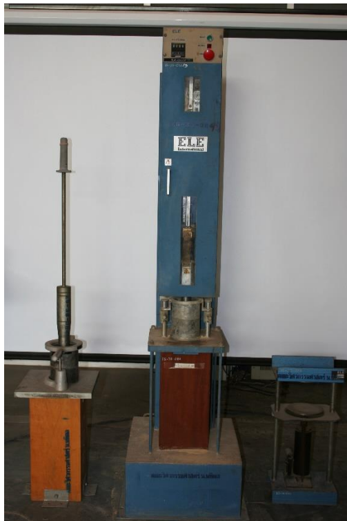
เครื่องมือบดอัดสำหรับเตรียมตัวอย่างส่วนผสมแอสฟัลติกคอนกรีตโดยวิธีมาร์แชล
