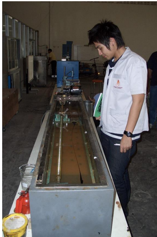
ชุดทดสอบการยืดตัวของแอสฟัลต์
