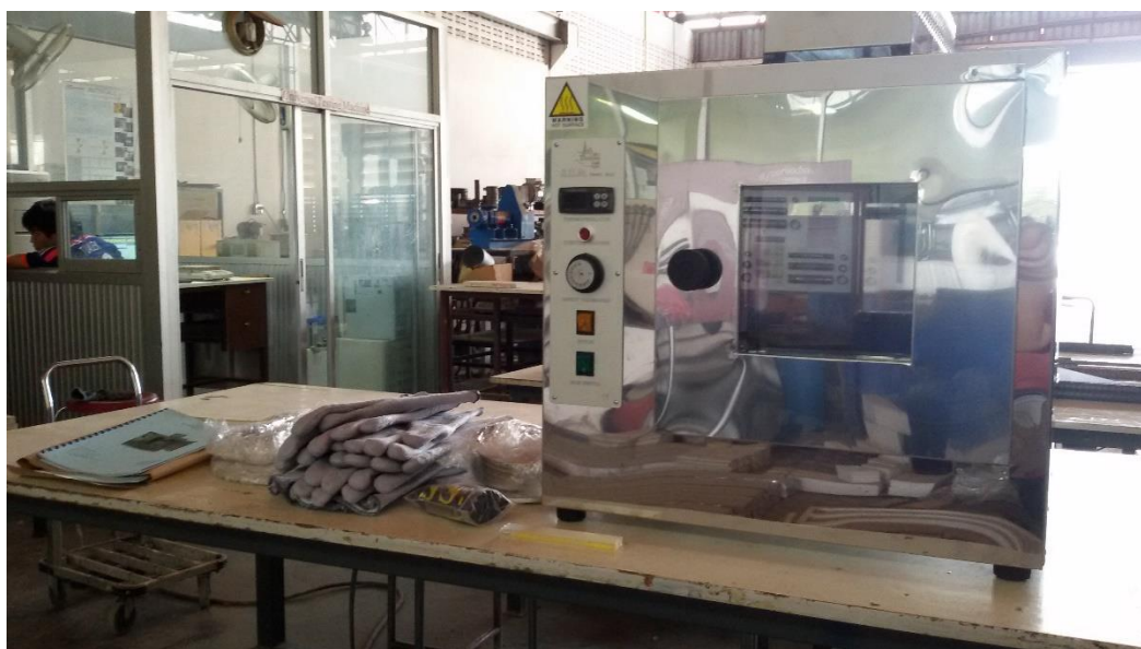
ชุดทดสอบการสูญเสียของวัสดุแอสฟัลต์เมื่อได้รับความร้อน
