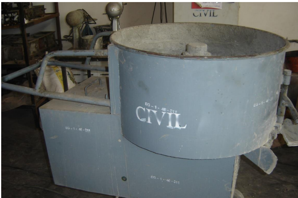
ชุดเครื่องผสมคอนกรีตแบบ Pan Mixer
