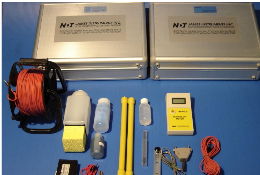
ชุดทดสอบแบบไม่ทำลาย : เครื่องมือทดสอบการเกิดสนิมในคอนกรีตเสริมเหล็ก
