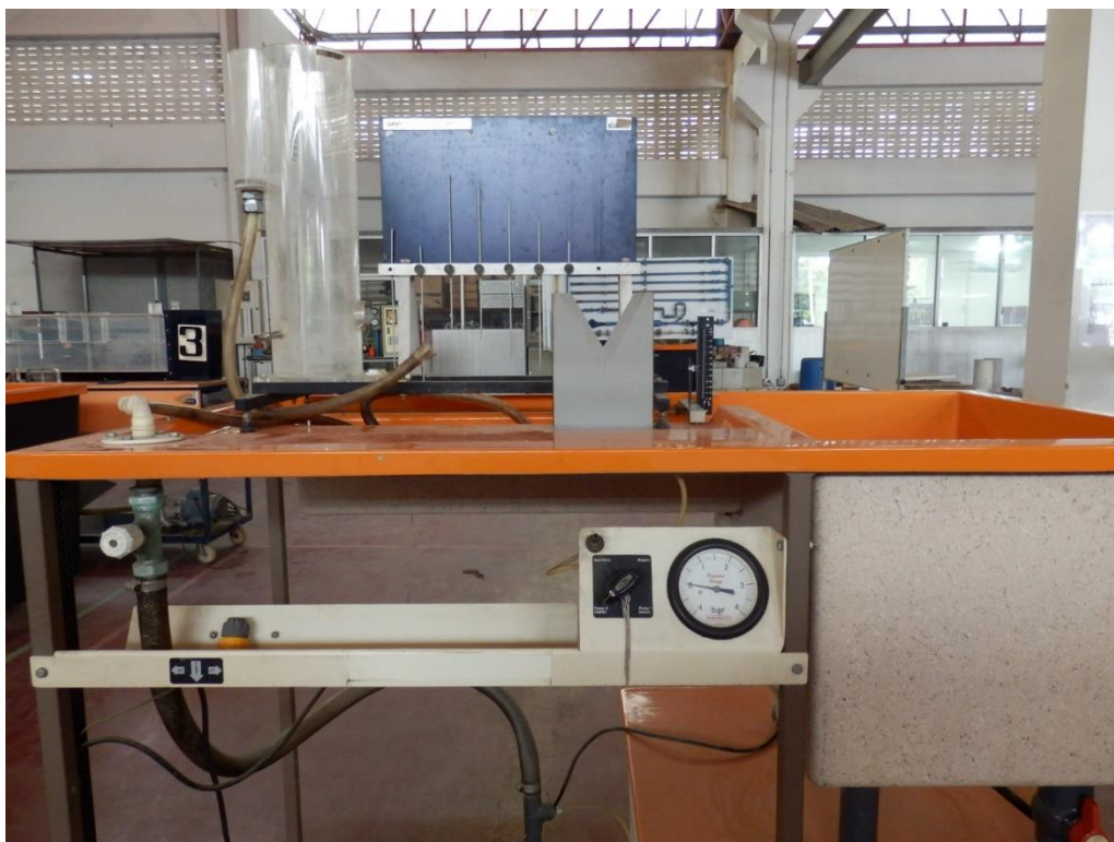
ชุดทดสอบการไหลผ่านฝายสันคมและรูระบาย
