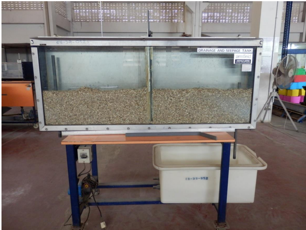
ชุดทดสอบการไหลซึมผ่านตัวกลาง
