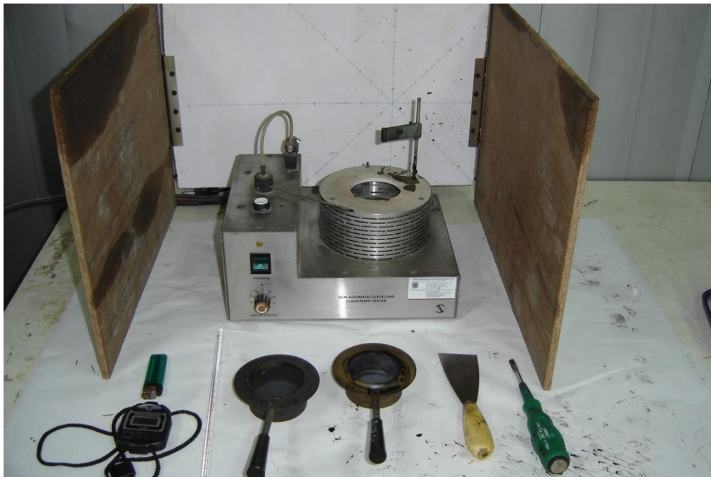
ชุดทดสอบจุดวาบไฟ และจุดติดไฟ
