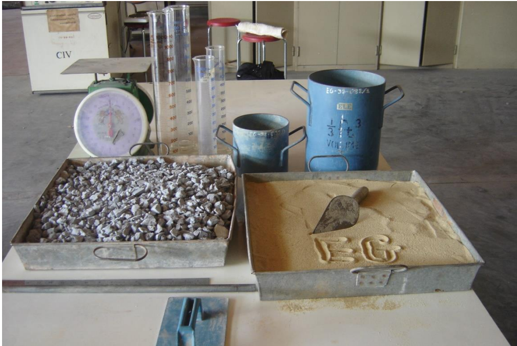
ชุดทดสอบหาค่าความถ่วงจำเพาะของวัสดุมวลรวมหยาบ และหน่วยน้ำหนักของมวลรวม
