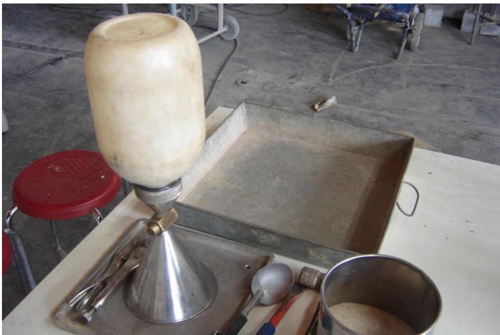
ชุดทดสอบการหาความหนาแน่นของดินในสนาม
