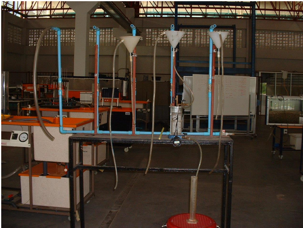
ชุดทดสอบการหาค่าความซึมน้ำได้ของน้ำผ่านดิน
