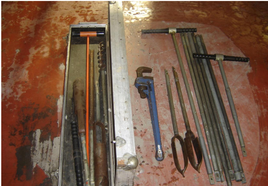
ชุดเครื่องมือเจาะเก็บและสำรวจตัวอย่างดิน
