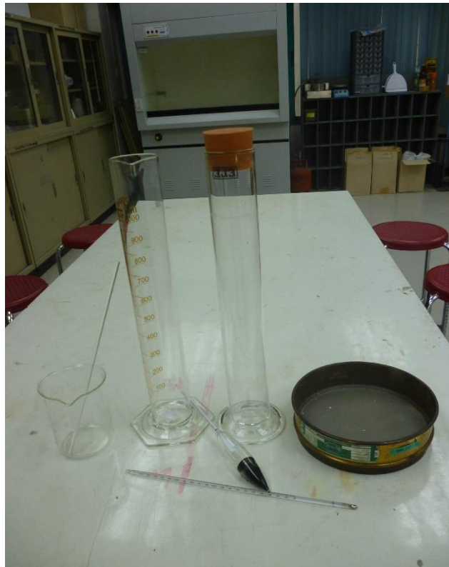
ชุดทดสอบการจำแนกขนาดของเม็ดดินโดยวิธี Hydrometer
