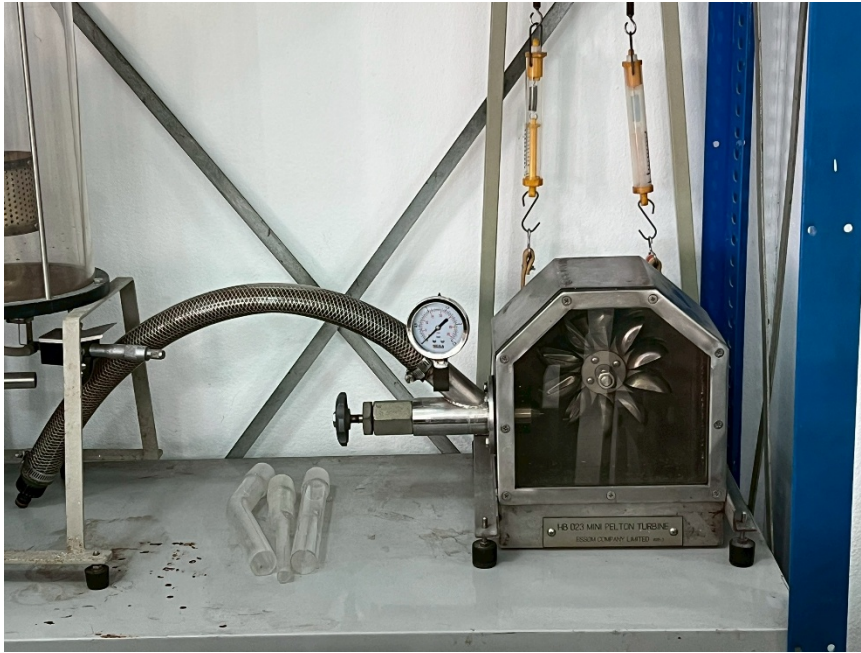
LAB04_03 ชุดปฏิบัติการทดสอบกังหันน้ำเพลตัน (Pelton turbine)
