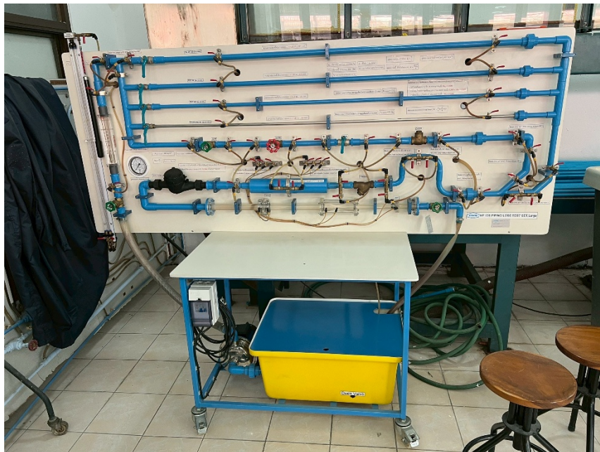
LAB04_01 ชุดปฏิบัติการการไหลและแรงเสียดทานในท่อ
