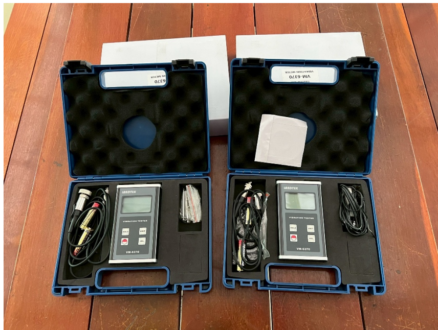
LAB01_03 ชุดปฏิบัติการวัดการสั่นสะเทือนของเครื่องยนต์
