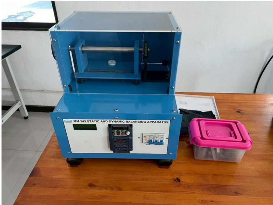
LAB01_01 ชุดปฏิบัติการสมดุลสถิตและไดนามิกส์
