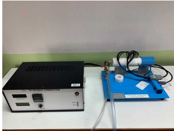
เครื่องทดสอบค่าการนำความร้อนด้วยวิธีการถ่ายเทความร้อนตามแนวแกน X
