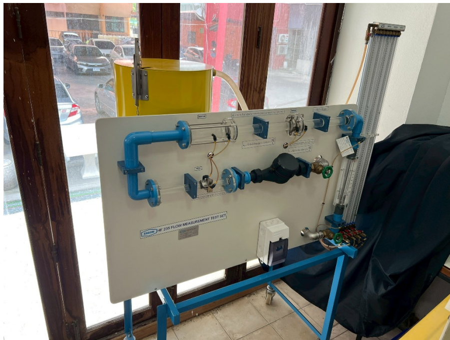
LAB04_04 ชุดปฏิบัติการการทดสอบอัตราการไหล
