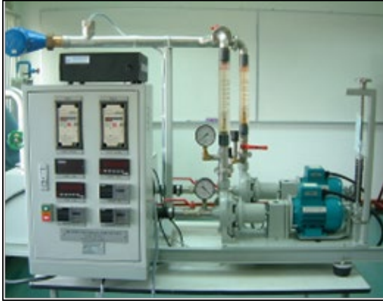
ชุดทดสอบ Multi Pumps Test
