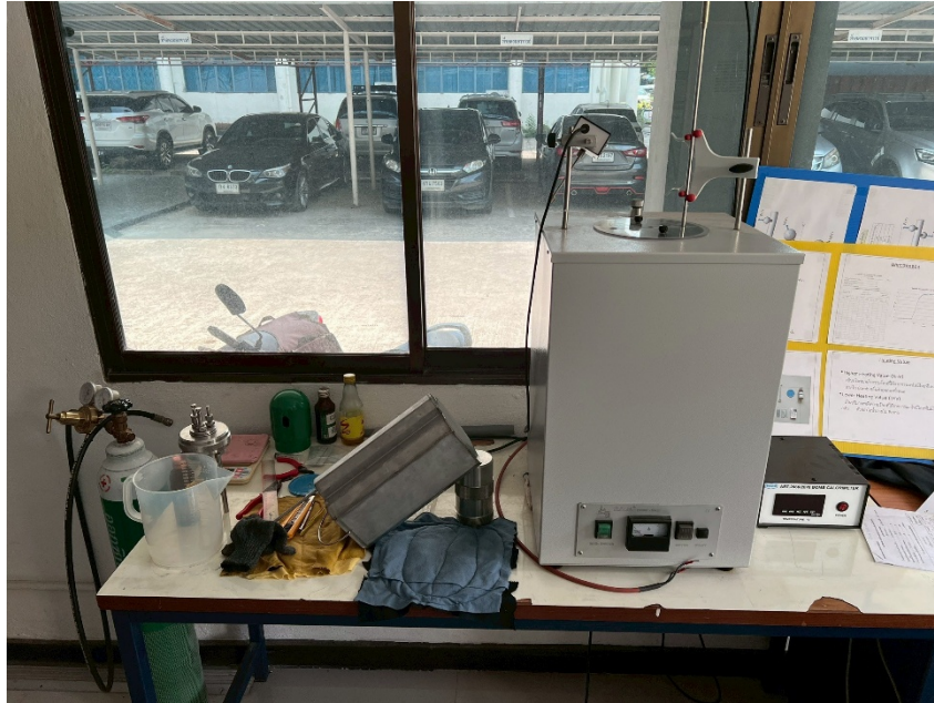
LAB03_09 ชุดการทดสอบหาค่าความร้อนเชื้อเพลิง
