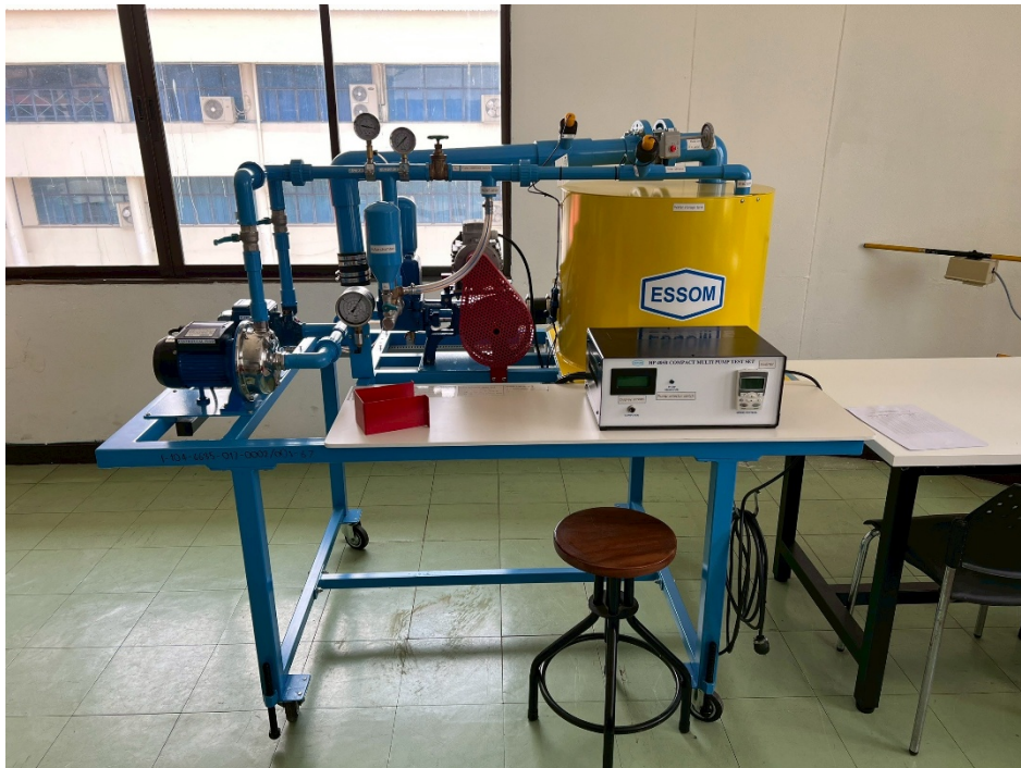
LAB04_02 ชุดปฏิบัติการการทดสอบสมรรถนะของปั๊ม
