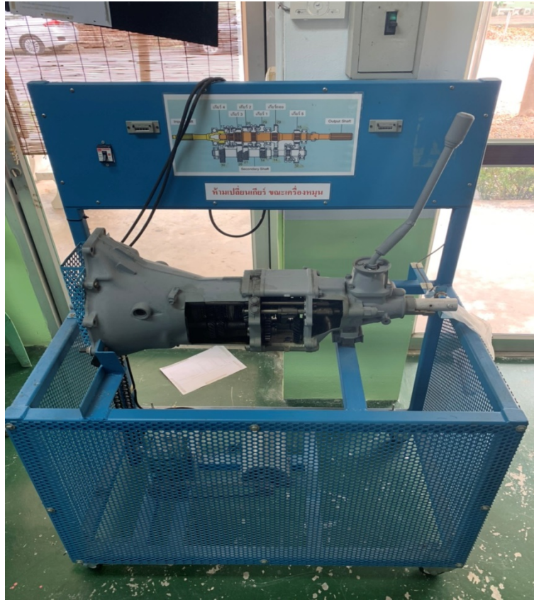
ชุดทดสอบเกียร์รถยนต์ธรรมดาขับหลัง เกียร์เดินหน้า 5 เกียร์ ถอยหลัง 1 เกียร์
